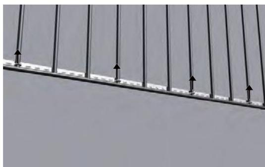
**Schritt 3:** Bringen Sie die drei Geländer Haken (B) gleichmäßig am Rahmen des Solarmoduls an, indem Sie das Befestigungsmaterial (F) verwenden.
