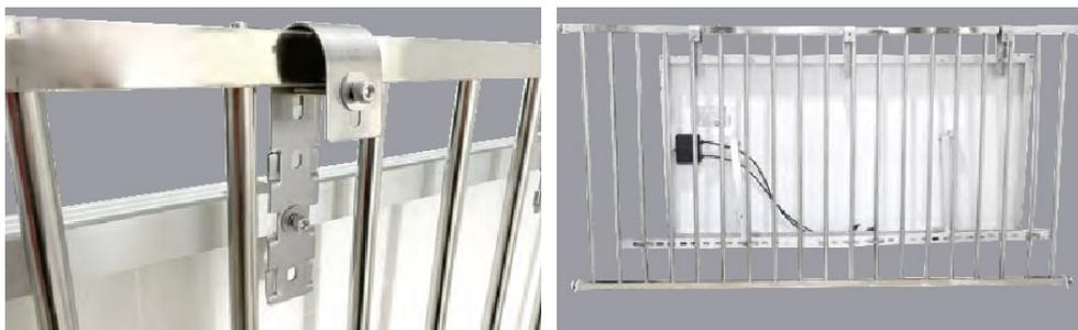
**Schritt 6:** Montieren Sie den Schieneneinsatz (L) an den L-Winkeln auf dem großen Rohr der verstellbaren Stangen. Führen Sie den Schieneneinsatz (L) in den Schlitz der Schiene ein und drehen Sie die Position so, dass sie senkrecht gegen den Schlitz der Schiene steht und vollständig gesichert ist.
